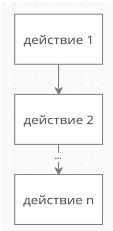
Рис. 107. Блок-схема линейного алгоритма
