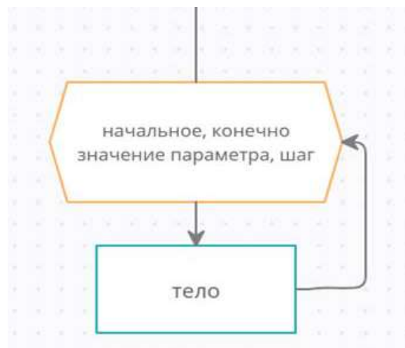
Рис. 58. Блок-схема цикла с параметром
