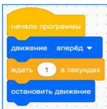
Рис. 18. Пример программы с использованием блока Ожидания
