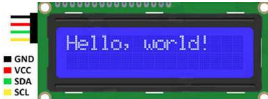
Рис. 1. Подключение модуля ЖКИ к Ардуино
